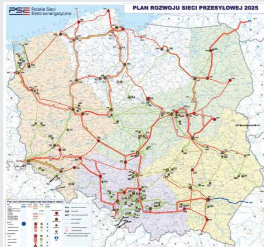
SCHEMAT ISTNIEJĄCEJ I ROZBUDOWYWANEJ INFRASTRUKTURY PSE
